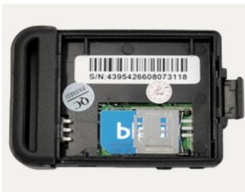
1. schieben sie die Arretierung für die SD-/Speicherkartenhalterung nach rechts und heben die Halterung von hinten nach vorne an.
